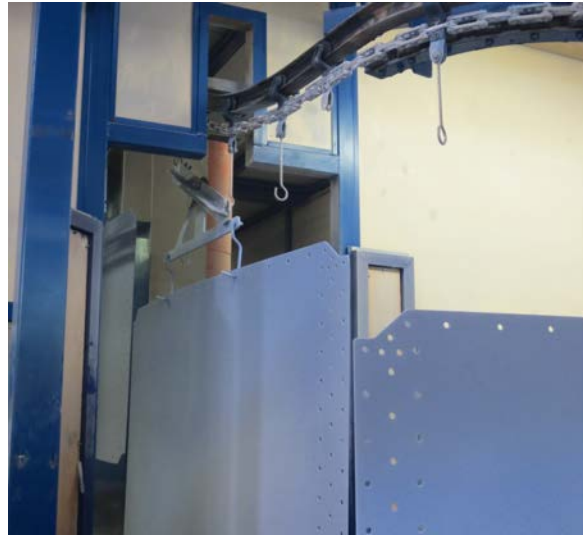
Figura 3 - Chapas saindo da câmara de aplicação do revestimento
