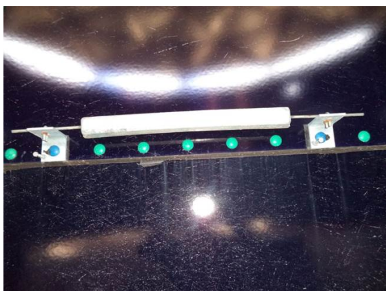
Figura 28 – Anodo de sacrifício instalado no tanque vitrificado pelo fornecedor
